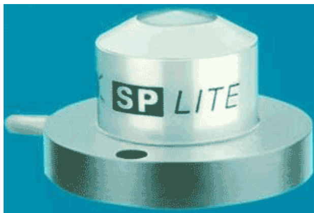
Slika 10. Poluvodički piranometar SP-lite Kipp & Zonen [2]
