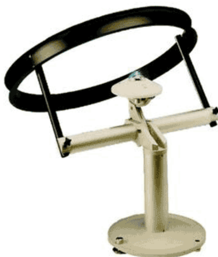
Slika 15. Piranometar CM11 Kipp & Zonen sa sjenilom CM 121 za mjerenje raspršenog Sunčevog zračenja [17]
