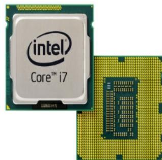
**Mikroprocesor** je elektronička komponenta koju računalo koristi za obavljanje svog posla. To je središnja procesna jedinica na jednom čipu s integriranim krugom koji sadrži milijune vrlo malih komponenti uključujući tranzistore, otpornike i diode koje djeluju zajedno.
